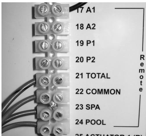
Figure 12. Bornier de l'appareil – Modèles analogiques
