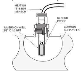
Figure 19. System Sensor (S3)
