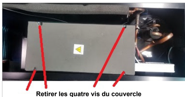
Figure 17. Retrait des vis du boîtier électrique
