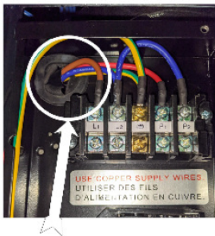
Figure 20. Insérer le câble sur la carte (modèles 1 vitesse seulement)
