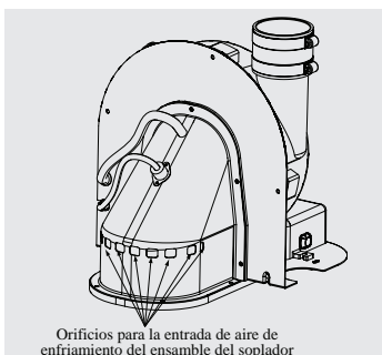
Orificios para la entrada de aire de enfriamiento del ensamble del soplador
