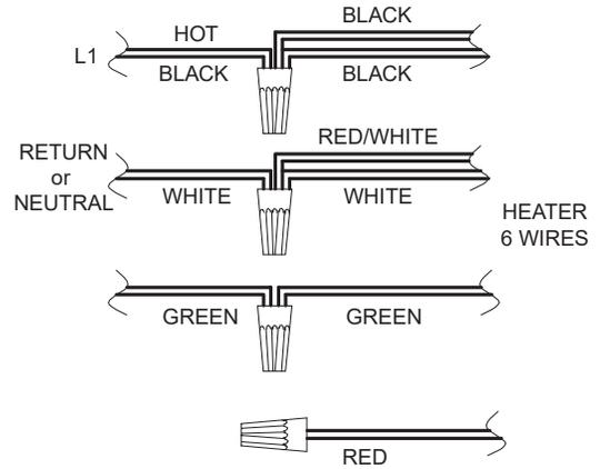
Figure 21. 120 VAC Wiring
