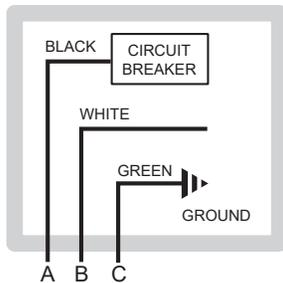
**Figure 29. Wiring Connections**
