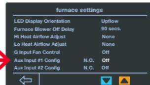
Configuración de la entrada auxiliar núm. 1 – N.A. (normalmente abierta) o N.C. (normalmente cerrada): opción para activar la entrada al control IFC de la caldera (consulta las instrucciones de instalación de la caldera).
